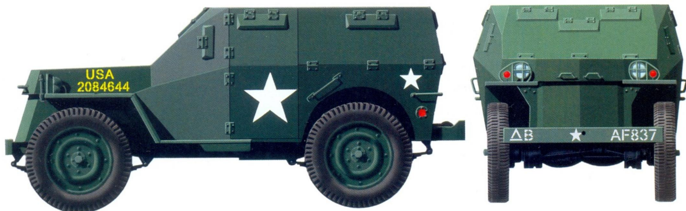
Опытные бронеавтомобили Т-25, выполненные на базе «Виллиса»
