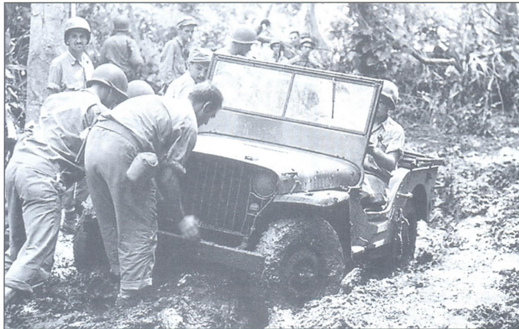
Виллис МВ первых серий. Фары уже перекочевали на переднюю панель, но радиаторная решетка пока еще сварена из отдельных прутьев
