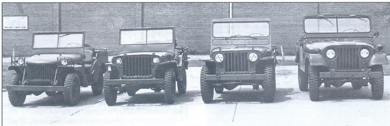
Так росли размеры военных джипов фирмы «Виллис»: Виллис «Квад» (1940 г.), Виллис MB (1942 г.), M-38 (1950 г.), M-38A-1 (1963 г.)
