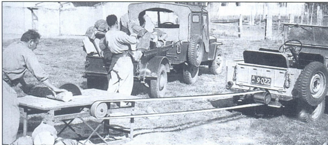
Сельскохозяйственный вариант CJ-2 с устройством отбора мощности и машина с прицепом
