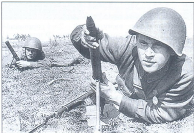
Необычный вариант использования лопаты — 37-мм миномет-лопата, применявшаяся бойцами Красной Армии в начале Великой Отечественной войны
