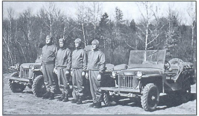
Усовершенствованные машины серии BR-B с упрощенными передними крыльями
