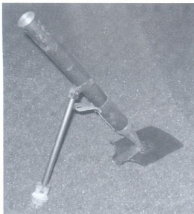
Необычный вариант использования лопаты — 37-мм миномет-лопата, применявшаяся бойцами Красной Армии в начале Великой Отечественной войны
